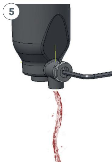
Otvorite odvod. Prljavština unutar filtra koju magnet više ne privlači bit će transportirana vani protokom vode u odvodu. Koristite spremnik za prikupljanje od najmanje 1 l.
