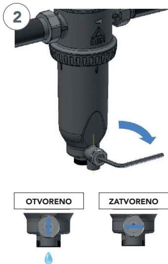
Otvorite odvodni ventil kako biste smanjili tlak u sustavu (10 sekundi) i ponovno zatvorite. Koristite posudu za sakupljanje vode u odvodu.
