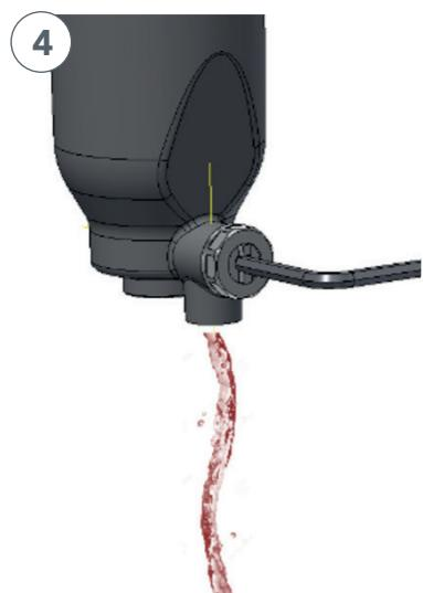
Otvorite odvod i ispraznite od vode sadržane unutra. Koristite spremnik za prikupljanje od najmanje 1 l.
