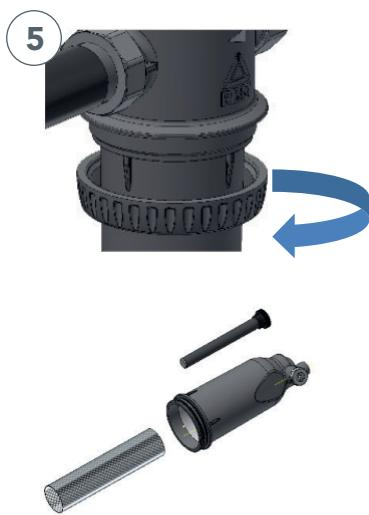
Odvijte prstenastu maticu. Otkačite tijelo. Izvadite magnet (spremite ga na čisto mjesto). Izvadite uložak od nehrđajućeg čelika. Operite tijelo i uložak pod mlazom tekuće vode.
