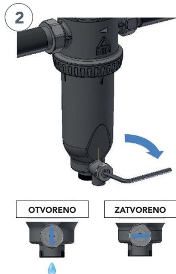
Otvorite odvodni ventil kako biste smanjili tlak u sustavu (5 sekundi) i ponovno zatvorite. Koristite posudu za sakupljanje vode u odvodu.
