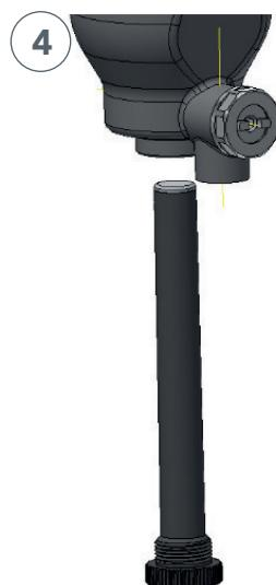
Odvijte magnet i izvadite ga. Odložite magnet na čistu površinu.
