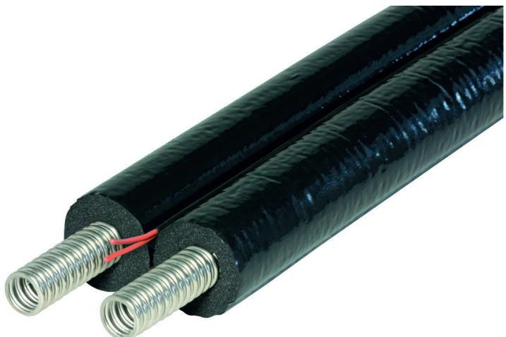
Sustav se sastoji od dvije cijevi od nehrđajućeg čelika, paralelno profilirane, vrlo fleksibilne i otporne na visoke temperature te UV zrake zahvaljujući SOLAR EPDM izolaciji od 14 mm debljine. Cijevi su povezane jednim slojem EPDM-a koji se može lako prezatati bez oštećenja izolacije. Setovi sadrže priključne dijelove za spoj kolektora i spremnika. Izrada spojeva ne zahtjeva upotrebu posebnih alata već se isto može učiniti s uobičajenim instalaterskim alatima odnosno ključevima.
